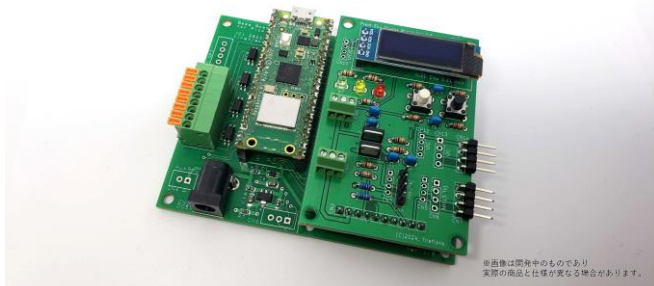
農家の方との対話から生まれた Raspberry Pi Pico W拡張ボード+植物生育環境計測ボード
